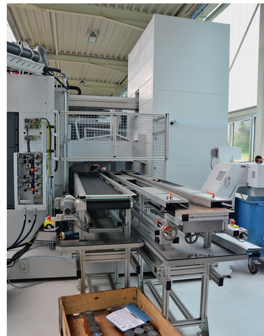
6 Vollautomatisierte 6-Seiten-Komplettbearbeitung: Zu- und Abführband des Stama-Fräsdrehzentrums transportieren die bis zu 25 kg schweren Teile zum integrierten Werkstückgreifer und wieder ab; rechts das angebundene Zusatz-Werkzeugmagazin mit 240 Plätzen © Hanser
